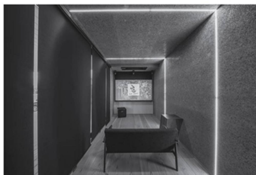
▲壁の片側が全面開放できるよう、サッシが取り付けられているのもオプション仕様。プロジェクター使用時はロールスクリーンを使って遮光できる。なお、スクリーンはコンテナの幅ギリギリに合わせたオーエスの特注品。空調を埋め込むためにふかした天井部分を利用し、電動式が収納されている
