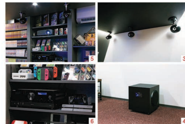
3 フロントおよびセンタースピーカーはイクリプスの「TD508MK3」をチョイス。遮音性能を損ねないように、埋め込みではなく天吊りできるモデルを選んだ。4 サブウーファもイクリプスで、16cmウーファーを2基対向配置したコンパクトなモデル「TD316SWMK2」を選んだ。5 6 JVCの4K/HDRプロジェクター「LX-NZ3」およびヤマハのAVアンプ「RX-A2A」は、視聴位置後方の棚に設置している。棚の奥行きは、ゆとりを持って機器を置けるように、井上氏が設計士に寸法を指定したのだとか。
