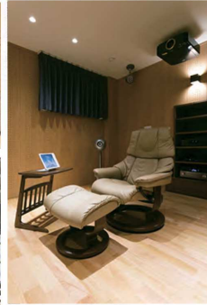
お一人でご覧になるので、椅子はストレスチェアにしたという。ホームオートメーションシステムを導入し、iPadでAV機器からエアコン、照明までワンタッチで操作できるようにした。窓は2重サッシにし、シャッターをつけることで音漏れと遮光対策も万全。
