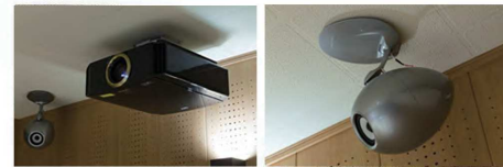
トップスピーカーにはイクリプス「TD508MK3」を天井り配置。スピーカースタンドごと設置できるので配線が見えにくく美しく設置できる。プロジェクターは4Kに対応すべくJVC「DLA-X990R」をチョイス。
