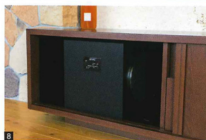
6 視聴位置の様子。一面が掃出し窓となっており、外にはバルコニーもある。7 AVアンプは締め切ったラック内にいれると熱が篋ってシャットダウンしてしまうこともある。そこでK君ではそうしたトラブルを防ぎつつ、ラック内をスッキリさせるために、隣室に設えたストレージに設置している。8 サブウーファー、イクリプス「TD316SWMK2」は、キャビネットが振動しないので、ラック内に入れている。9 レコーダーやゲームなど、ディスクの管理が必要な機器はラック内に収めている。
